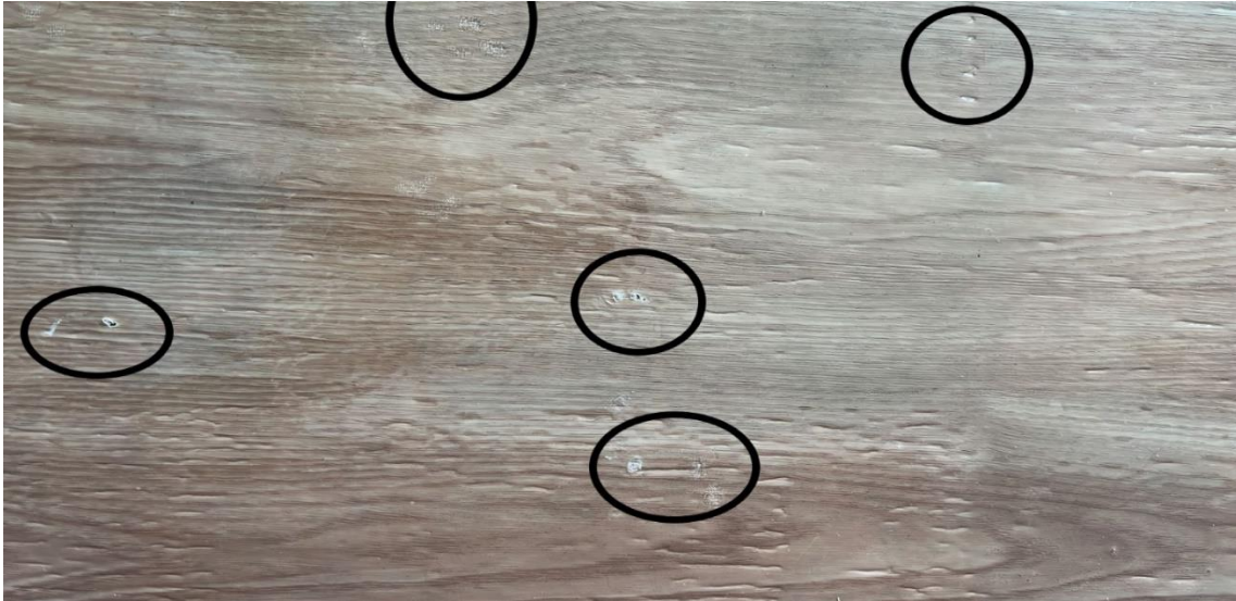
Figura 4 – Imperfeições apresentadas pela baixa resistência da resina
